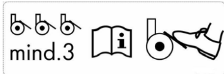
Teil C: Abb.2: Bremsen der Laufrollen
